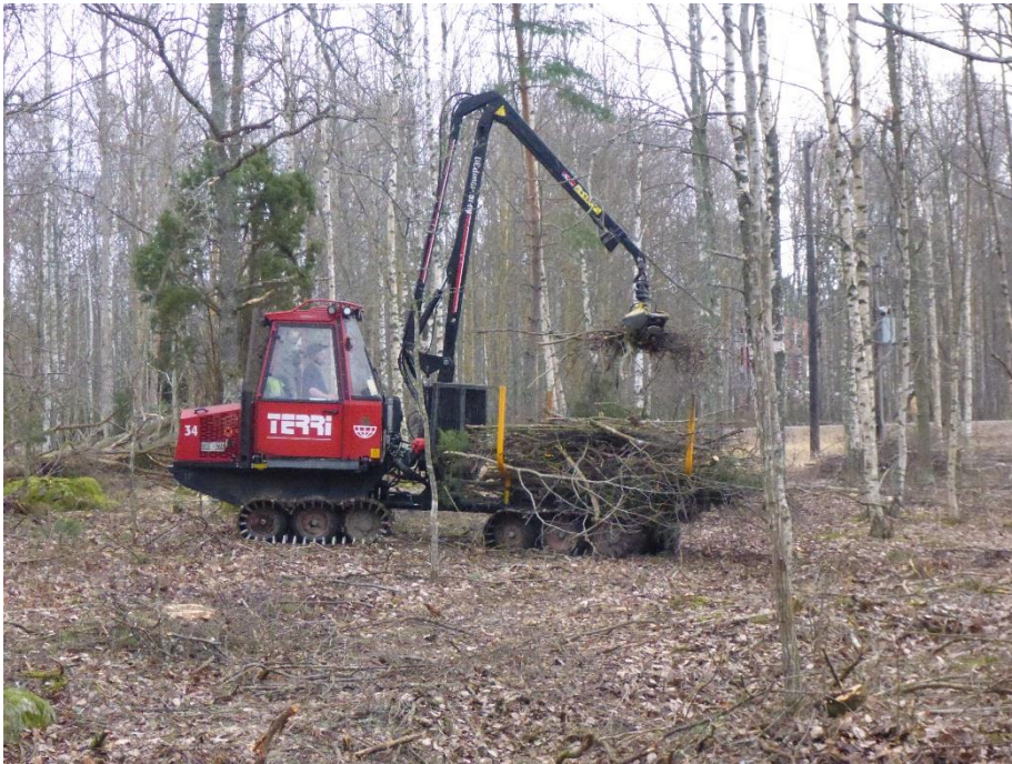
Skotning med beståndsgående skotare i fuktiga lövpartier V om väg 210. För att undvika körskador används band. (Terriskotning_20160302_Herrborum_MJn)
