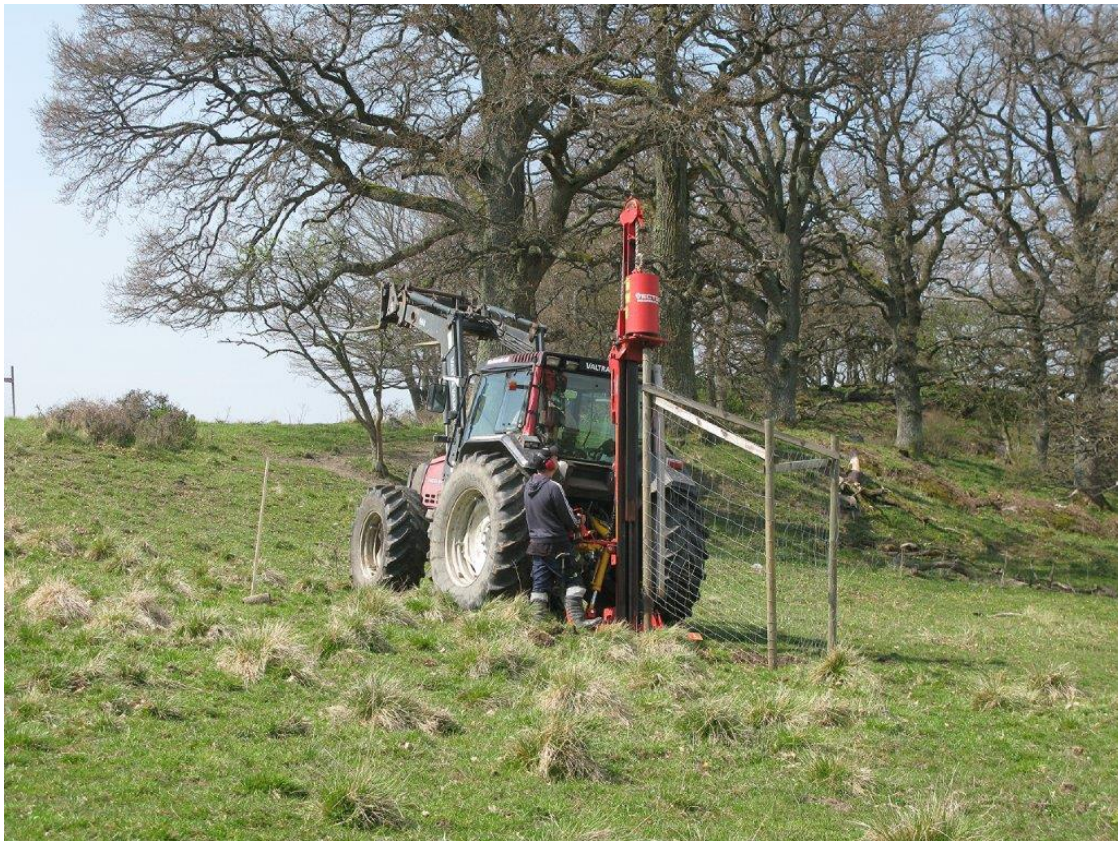
Burar har monterats för att skydda planterade ekplantor. Stolpnedslaga har använts för att få ner stolparna djupt i marken (6 dm) så att burar blir stabila. Tre plantor i vadera bur.
