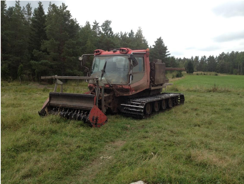
C1 Denna specialutrustade pistmaskin gjorde delar av jobbet och äter både tuvor och stubbar. (C1_Bråxvik_specialutrustad pistmaskin_MLn.JPG)
