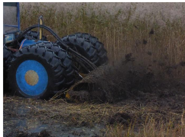
C1 Fräsen river sönder vassrötterna. (C1_Ramnö_vassfräsen jobbar_MLn.JPG)
