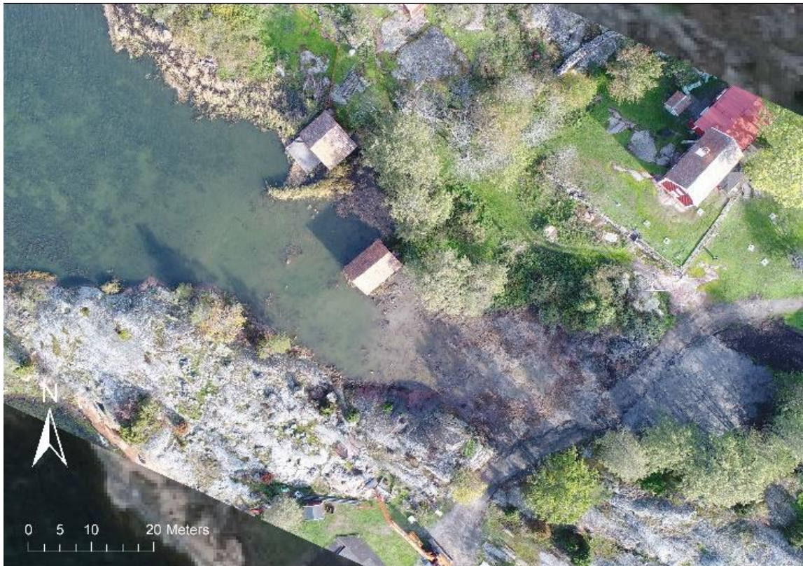
Figur 7. Efter genomförd åtgärd, oktober 2018. Vassens rotfilt har grävts bort framför de båda sjöbodarna och massorna har flyttats till östra kanten av bilden, på andra sidan grusvägen. Allra närmast bodarna kunde maskinen inte gräva då det riskerade att bli sättningar i byggnaderna om massorna flyttades.
